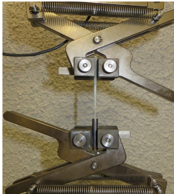
Figure 37. Illustration du dispositif utilisé lors du test de rétention [11]
